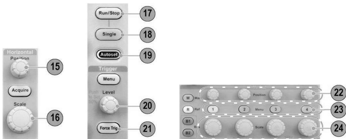
15. 水平位置 旋轉此旋鈕可以調整觸發點相對於採集的波形的位置。按“精細”可以進行更小調整。
