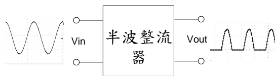
圖 3 經過一個二極體所產生的半波波形。
